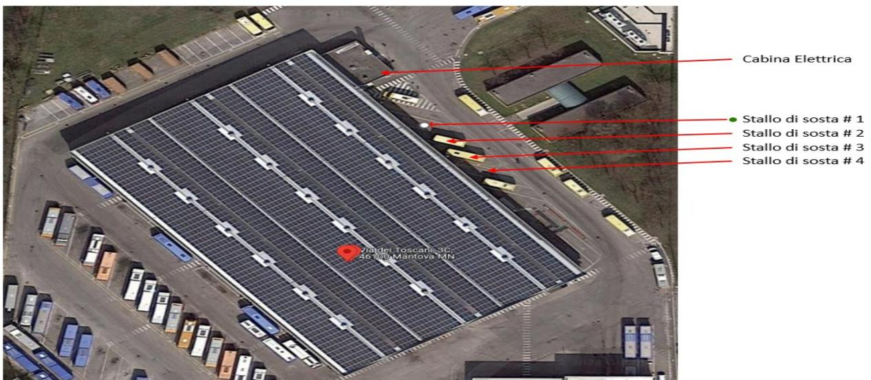
Apam renderà disponibile, in prossimità della cabina elettrica, un cavo di potenza opportunamente dimensionato per alimentare la stazione di ricarica oggetto di fornitura. Nella fornitura sono incluse tutte le opere edili (scavi, posa di cavidotti, pozzetti, botole carrabili e relativi ripristini) e della carpenteria metallica per il fissaggio e supporto delle
